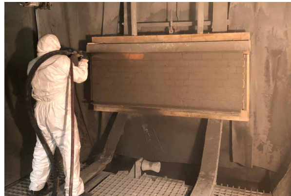
Bild 2: Spritzbetonversuchsstand der Ruhr-Universität Bochum; Auftrag Geopolymerspritzbeton auf einer Mauerwerksstruktur
