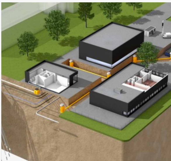
Bild 2: Mit gutem Beispiel voran geht das Fraunhofer IEG an seinem Standort in Bochum, welches es mit oberflächennaher Geothermie erschlossen hat und so seinen Wärme- und Kältebedarf deckt. In Zukunft will es im Reallabor TRUDI auch das Potenzial für die Tiefengeothermie erkunden. (© Fraunhofer IEG)
